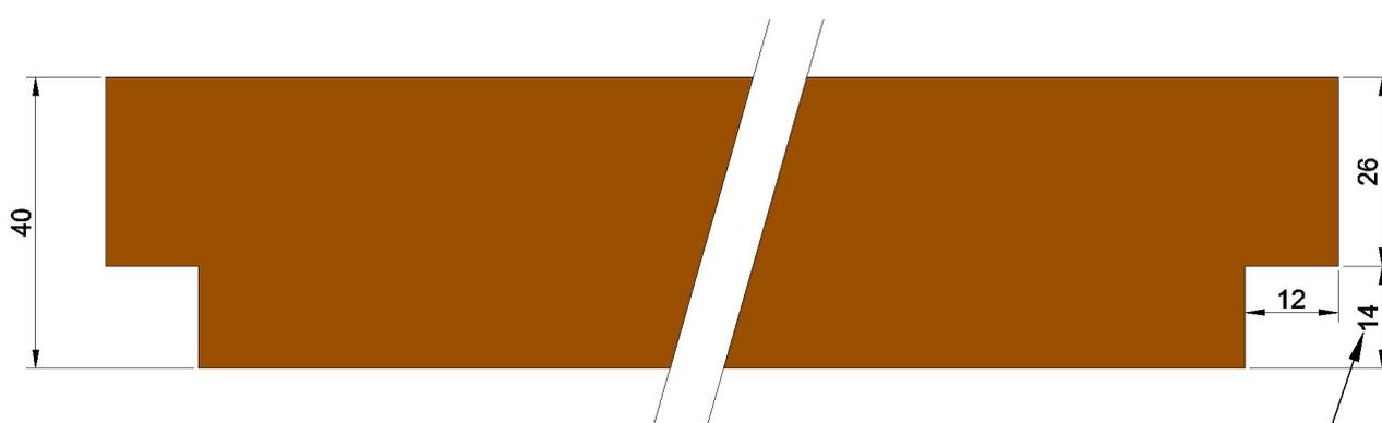
Mesure pour joint 5 mm
