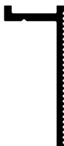
Mesure pour joint 5 mm
