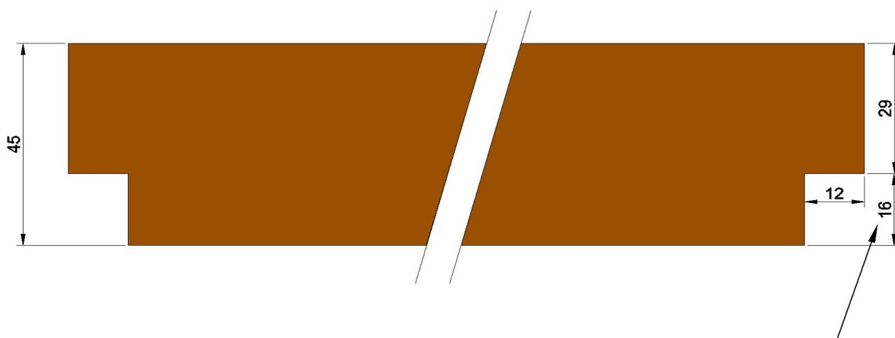
Mesure pour joint 5 mm
