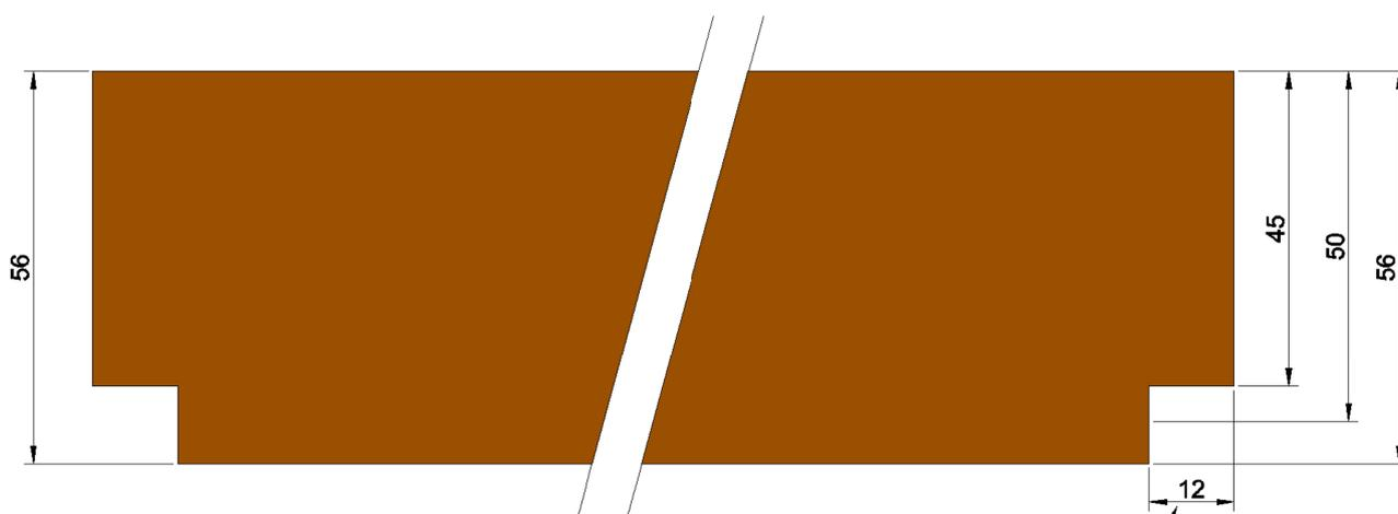
Mesure pour joint 5 mm
