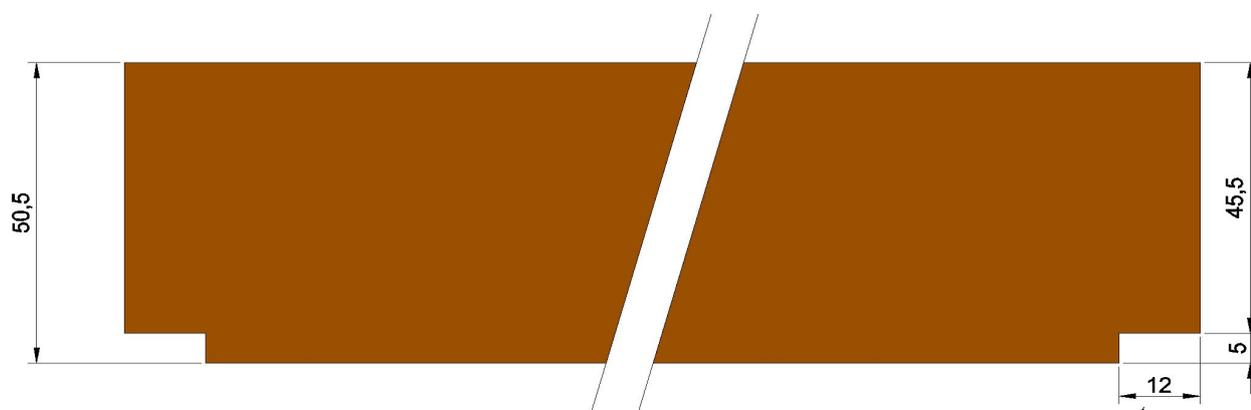
Mesure pour joint 5 mm
