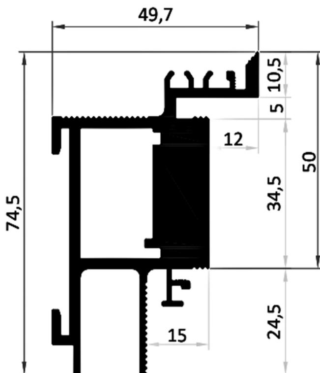
Mesure pour joint 5mm
