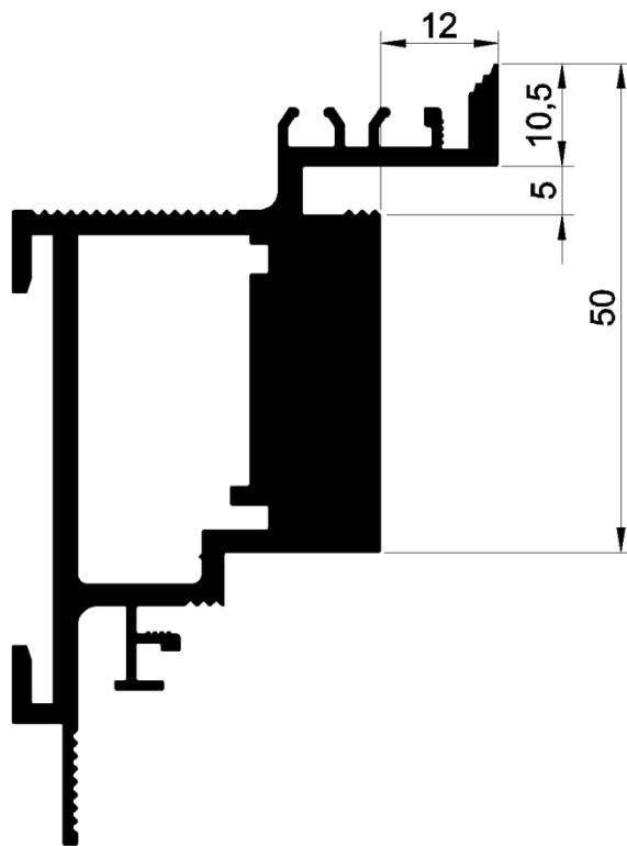
**Mesure pour joint 5mm**
