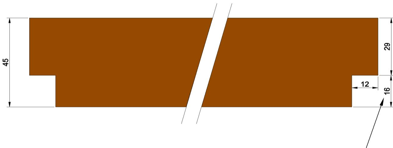
Mesure pour joint 5mm
